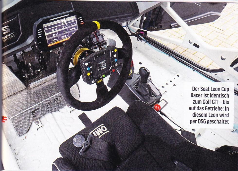
Der Seat Leon Cup Racer ist identisch zum Golf GTI – bis auf das Getriebe: In diesem Leon wird per DSG geschaltet
